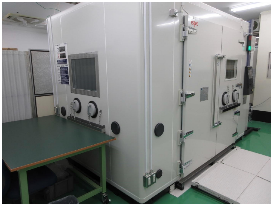
左側面(観測窓/操作孔/ケーブル孔)
